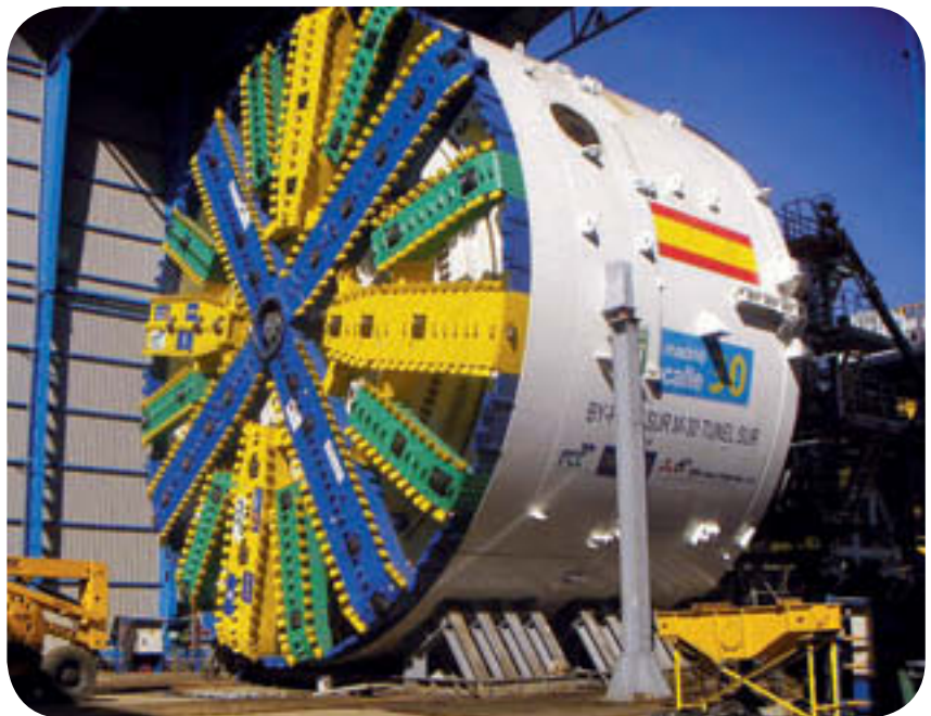
SKF har konstruerat och tillverkat två svängkransrullager utförda som kryssrullager med en yttre diameter på 5,7 m och 5,9 m för världens största jordtrycksbalanserade tunnelbörningsmaskin från MHI-Duro Felguera. Den kolossala EPB-maskinen ska användas för att bygga en fyra kilometer lång genomfartstunnel i anslutning till Madrids ringled M30, vilken beräknas öppnas för trafik i mars 2007.
