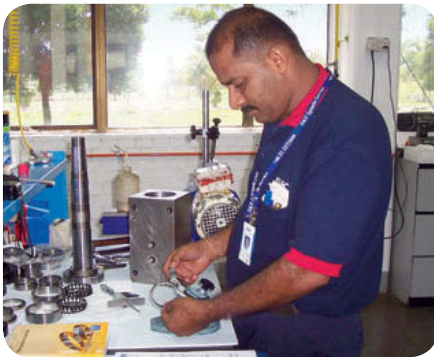
SKFs verksamhet Spindle Service omfattar totalt 15 renoveringscenter runt om i världen. I juni 2005 invigdes centret i Nilai, Malaysia. Bilden visar Ravichandar Ramoo som utför mätning av distanser för justering av förspänningen i högprecisionslager. Centret kommer att stödja lokala slutanvändare av verktygsmaskinsspindlar med professionell renovering av spindlar av alla slag och varumärken.
