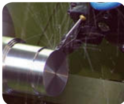
Bearbetning med minimal smörjning (MQL).
